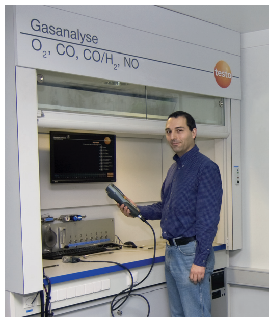
Testo Rauchgas-Prüfstelle: norm-konforme Überprüfungen Ihrer Rauchgas-Messgeräte (jedes Fabrikat, jede Type)
