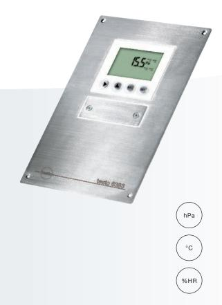
Le capteur de pression différentielle testo 6383 a été spécialement conçu pour le contrôle des pressions différentielles faibles dans une étendue de 10 Pa à 10 hPa. En salles blanches, le maintien d'une surpression dans la zone critique permet d'éviter l'arrivée d'un air pollué. Grâce à une sonde d'humidité disponible en option de la série testo 6610, il est également possible de relever simultanément la température et l'humidité dans un seul appareil.
