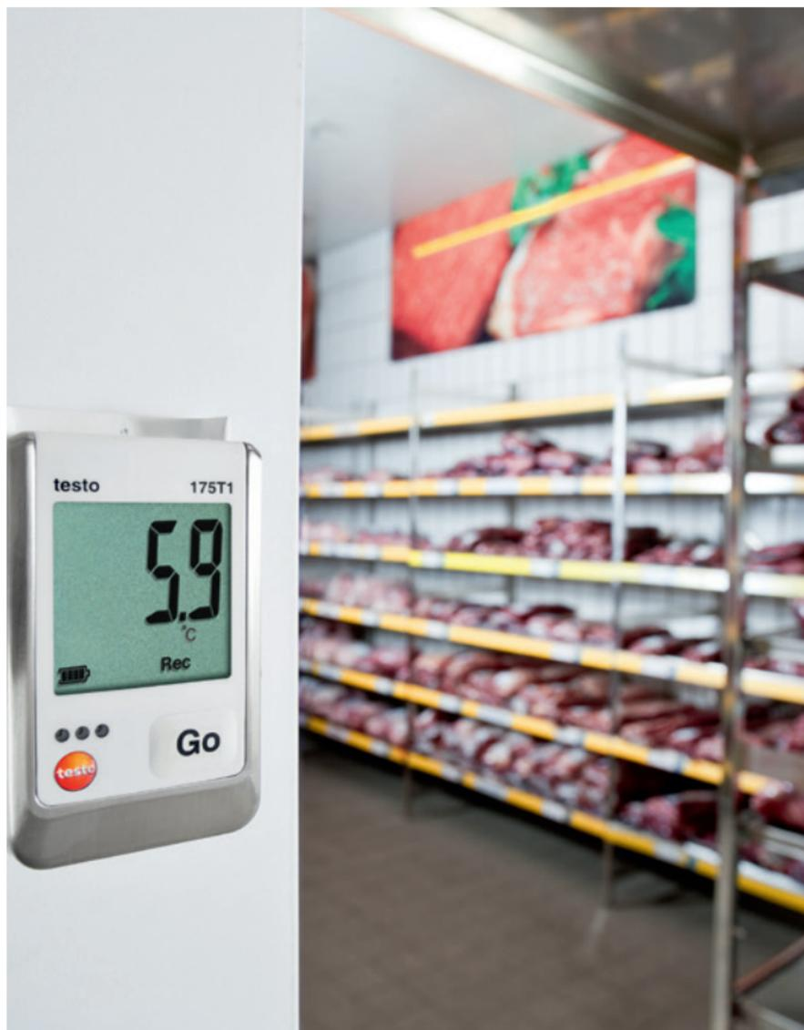
Abb. 16: Temperaturüberwachung im Kühlraum mit testo 175T1
