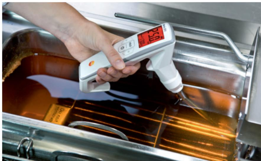
Abb. 11: Messung des TPM-Wertes in Frittieröl mit dem testo 270
