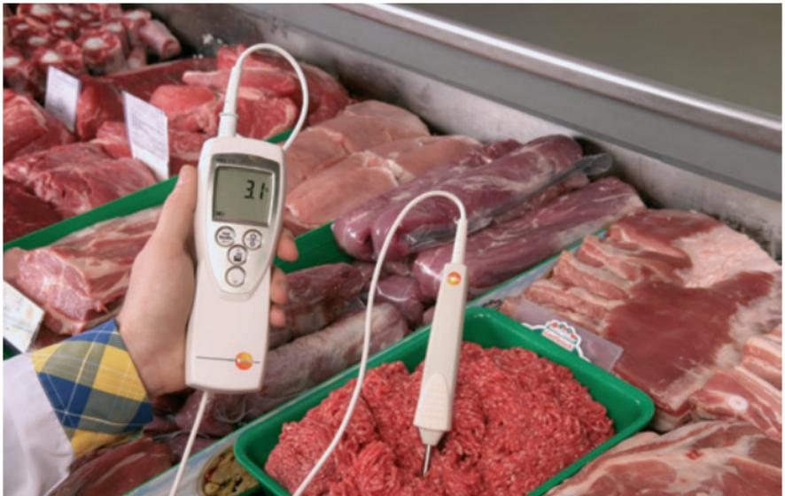
Abb. 18: Anwendung testo 112 mit Einstechfühler
