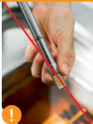
Fassen Sie den heißen Fühler nicht an. Es besteht Verbrennungsgefahr.
