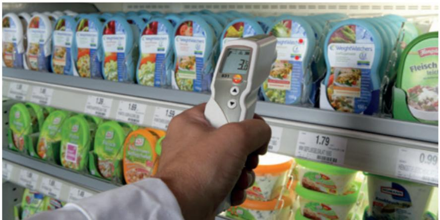
Abb. 5: Infrarot-Messung der Oberflächentemperatur an Nahrungsmitteln
