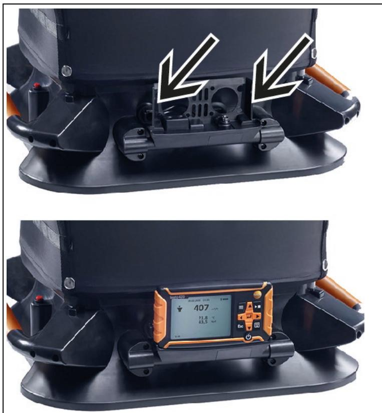
1. testo 420 をベースのホルダーに押し込みます。左右のブラケットに沿うように注意して行ってください。
