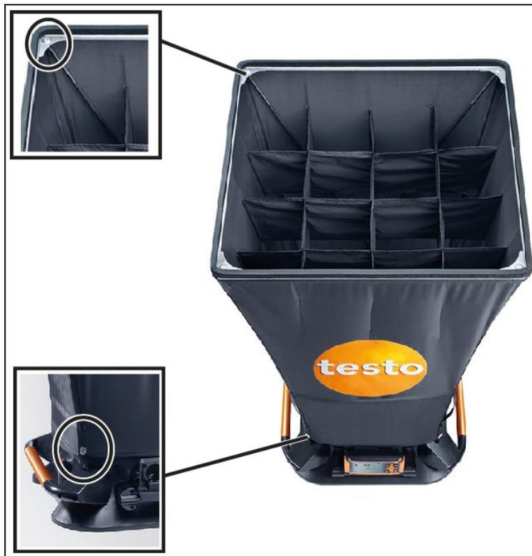
1. フードの下側の端をベースにかぶせます。対角に2箇所あるスナップボタンをあわせませす。
