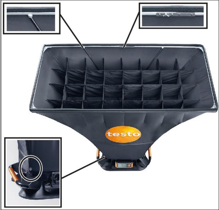
1. アルミフレームを固定して、枠組みに合わせてフードを伸ばして合わせます。ゴムバンドが枠のくぼみにはまるようにします。ゴムバンドが正しくくぼみにはまっているか、特に角の部分を確認して下さい。
