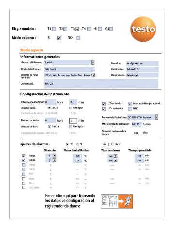
Para configurar un registrador testo 184 no es necesario instalar un software en el PC u ordenador portátil. La herramienta de configuración PDF está almacenada en el mismo registrador y puede abrirse con un doble clic.
