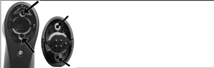
2. Limpie con aire los canales del gas de combustión del módulo de la sonda con aire comprimido (véase la ilustración). No utilice cepillos.
