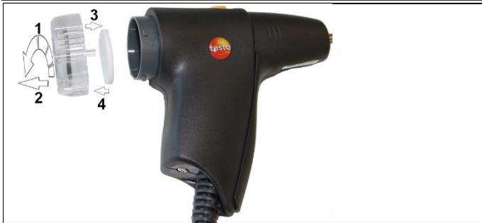
1. Abrir la cámara del filtro: Gírela ligeramente en sentido contrario a las agujas del reloj (1). Retire la cámara del filtro (2).
