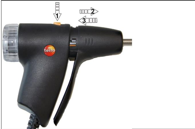
1. Pulse la tecla situada en la parte superior de la empuñadura (1) y retire el módulo de la misma (2).
