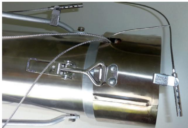
Möglicher Einsatzbeispiel des Hitzeschutzbehälters. Im Inneren befindet sich der Datenlogger testo 176 T3 mit einem Ersatzmesskopf (Best.-Nr. 0602 0092) zur Messung der Innentemperatur des Behälters, einer Temperatur-Messspitze (Best.-Nr. 0602 5792) und zwei speziellen Backofen-Fühlern mit Klammern (Best.-Nr. 0699 7002/1) zur Messung an vor-/hinterherfahrenden Behältern oder Blechen.
