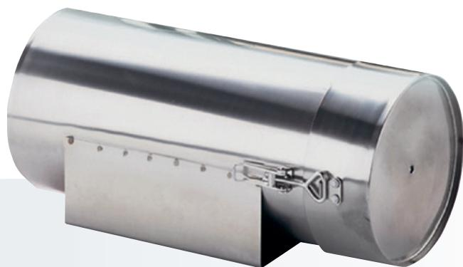
Im Inneren des Hitzeschutzgefäßes wird ein Messgerät mit Speicherfunktion platziert (z. B. Datenlogger testo 176). Der vakuumisierte Spezialglasbehälter isoliert die Elektronik des Messgerätes gegen Strahlungs- und Kontaktwärmе. Nach 1,5 h in einer Umgebungstemperatur von +200 °C steigt die Temperatur im Behälter auf max. +70°C.
