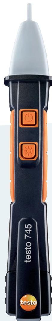
Le contrôleur de tension sans contact testo 745 doté d'une étendue de mesure de tension jusqu'à 1000 V AC convient tout particulièrement pour un premier contrôle rapide en cas de source d'erreur supposée. Lorsqu'une tension alternative est constatée, le testo 745 l'indique par des signaux visuels et sonores clairs.
