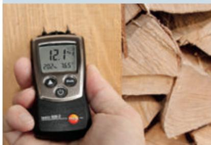
**Solution :** mesure rapide et non destructive de l'humidité des matériaux.
