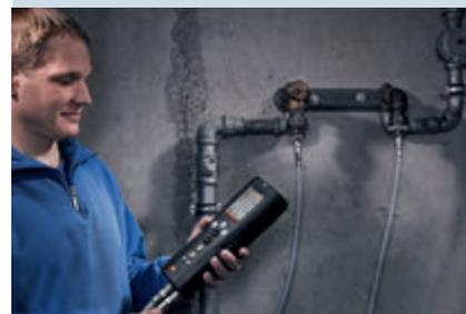
**Solution :** contrôle d'étanchéité avec un appareil de mesure certifié ainsi que documentation numérique des résultats comme preuve valide.
