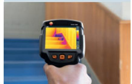
**Solution :** mesure de la température sans contact.
