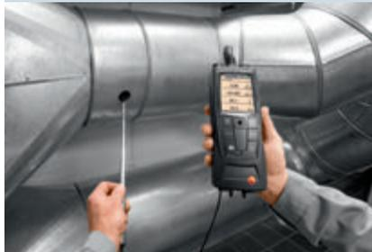
**Solution :** instructions pas-à-pas pour la mesure en réseau CTA et sondes pouvant être étalonnées individuellement.
