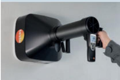
**Solution :** mesure précise de l'écoulement avec un redresseur.
