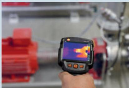
**Solution :** détection précoce des phénomènes d'usure par la détermination de l'augmentation de la température sans contact aux composants.
