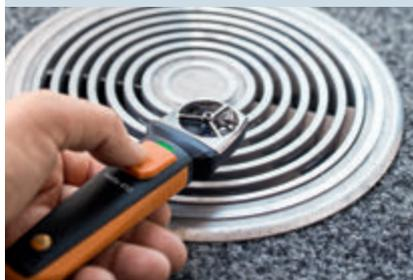
**Solution :** mesurer et adapter le débit volumétrique dans la canalisation et à sa sortie.
