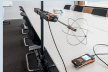
**Solution :** évaluation globale des conditions climatiques avec un appareil multifonctions. Évaluation du confort thermique conforme aux normes selon PMV/PPD. Détermination de la qualité de l'air intérieur.
