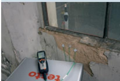
**Solution :** une mesure simple du coefficient de transfert thermique (valeur U) informe sur le pouvoir isolant.
