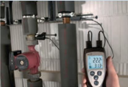
**Solution :** mesure de la différence entre les températures des canalisations montantes et descendantes pour préparer l'équilibrage hydraulique.
