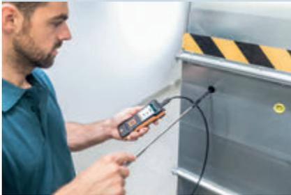
**Solution :** mesure de la vitesse d'écoulement et du débit volumétrique dans la canalisation d'air.
