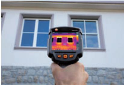
**Solution :** visualisation thermographique de l'ensemble de l'enveloppe du bâtiment avec une caméra thermique.
