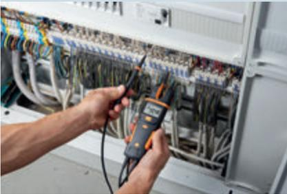
**Solution :** mesure du courant et de la tension dans l'armoire électrique, aux installations de pompes à chaleur, aux compresseurs et aux installations de climatisation.
