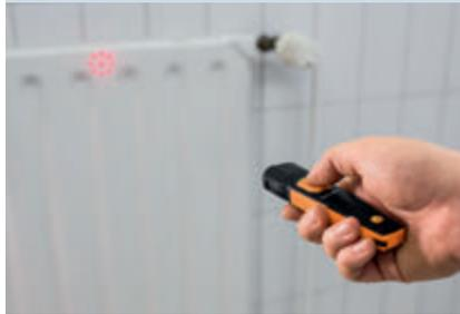
**Solution :** mesure de la température sans contact.
