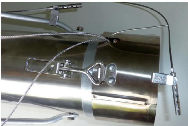
Mögliches Einsatzbeispiel des Hitzeschutzbehälters. Im Inneren befindet sich der Datenlogger testo 176 T3 mit einem Ersatzmesskopf (Best.-Nr. 0602 0092) zur Messung der Innentemperatur des Behälters, einer Temperatur-Messspitze (Best.-Nr. 0602 5792) und zwei speziellen Backofen-Fühlern mit Klammern (Best.-Nr. 0699 7002/1) zur Messung an vor-/hinterherfahrenden Behältern oder Blechen.
