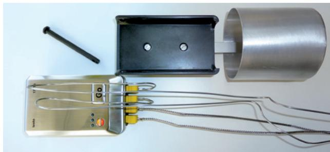
So könnte das Innenleben des Hitzeschutzbehälters vor der Montage aussehen: Behältereinsatz mit angeschraubter Datenlogger-Halterung und Verriegelungsstift sowie dem Datenlogger testo 176 T3 mit vier externen Temperaturfühlern.
