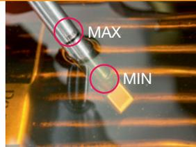
Immergere il sensore nell'olio caldo. Osservare le tacche Min/Max!
