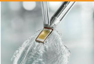
Pulire lo strumento con un detergente per piatti delicato. Sciacquare il sensore sotto acqua corrente e asciugarlo con un panno di carta morbido.
