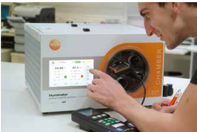
采用触摸式控制面板进行探测器的校准设置
