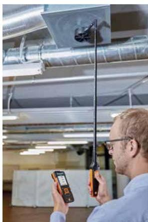
Klar strukturierte Menüs für Volumenstrom, k-Faktor, Turbulenzgrad, Heiz-/Kühlleistung, Schimmelindikation und Langzeitmessung sind im Gerät hinterlegt.
