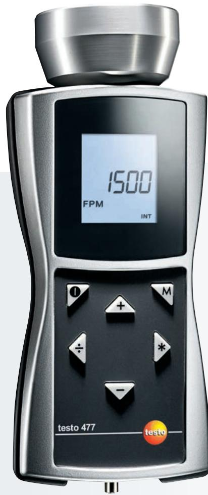
Le stroboscope à LED portable testo 477 est utilisé lorsqu'il est nécessaire de faire apparaître des objets se déplaçant rapidement sous une chronoloupe. Le testo 477 visualise les mouvements de rotation et vibratoires – et ce, même pendant le fonctionnement. L'image « figée » ainsi obtenue permet une inspection et une analyse qualitative des pièces se déplaçant avec des fréquences élevées.
