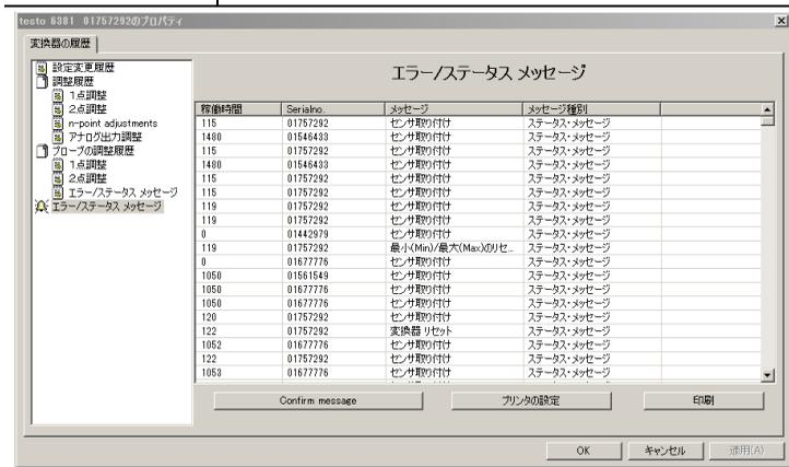
変換器で生成されたエラー・メッセージやステータス・メッセージを表示します。(変換器内に保存されていたメッセージは、P2Aソフトウェアとの接続時にPC内の該当の計測器ファイルに転送・保存されます)
