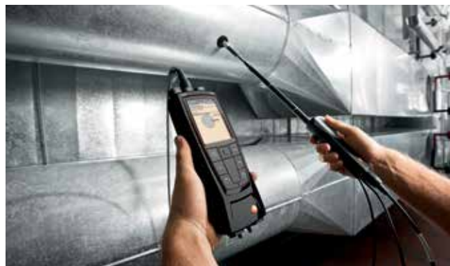
Las sondas de velocidad con escala facilitan la determinación de la profundidad de inmersión en el conducto.
