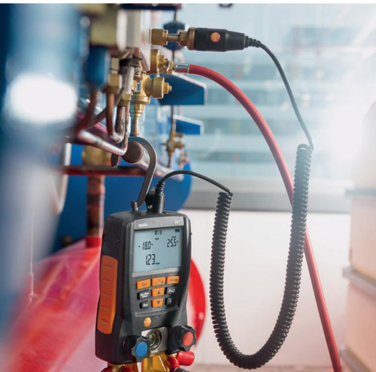
Hochpräzise Vakuummessung: testo 557 mit externer Sonde.
