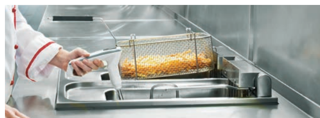
testo 270を使用した食用油の品質測定
