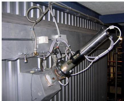
Infrarot Strahlungsthermometer mit Fensteradapter.
