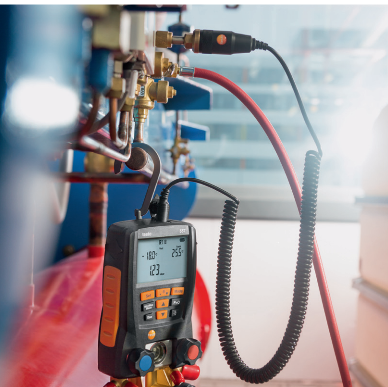
Măsurarea exactă a vacuum-ului: testo 557 cu sonda externă
