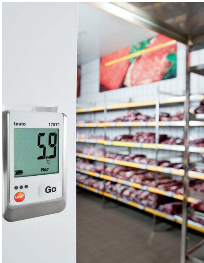
Afb. 16: Temperatuurbewaking in de koelruimte met testo 175T1
