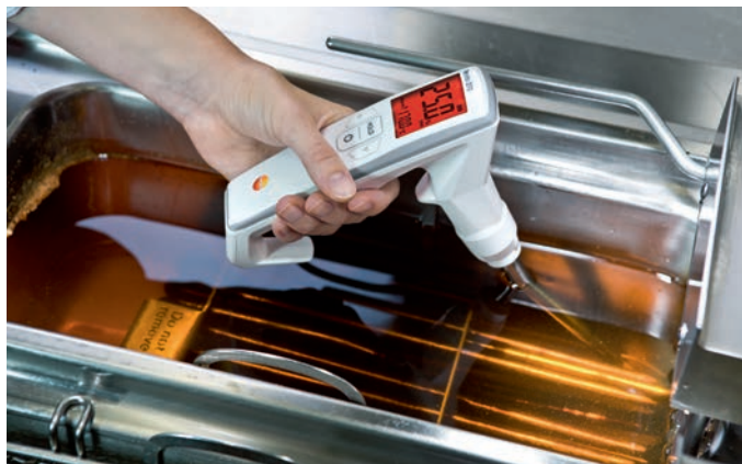
Afb. 11: Meting van de TPM-waarde in de frituurolie met de testo 270
