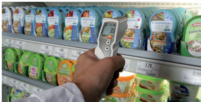
Afb. 5: Infrarood meting van de oppervlaktetemperatuur aan voedingsmiddelen
