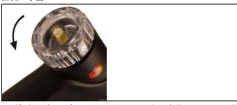
1. 排ガス・プローブのフィルタ・チャンバーを反時計回りに回して、開きます。
