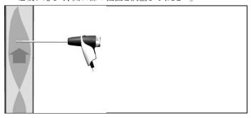
プローブの先端を、排ガスの流れの中央に必ず配置してください。
