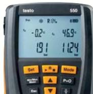
Integrazione App tramite Bluetooth per la visualizzazione dei valori di misura su dispositivi mobili, con completamento del rapporto di misura sul posto.
