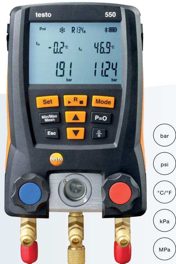
Nuovo testo 550, strumento robusto per il lavoro quotidiano su impianti di refrigerazione e pompe di calore. Il blocco valvole a 2 vie con 3 connessioni e 3 attacchi per flessibili permette un lavoro più rapido e semplice.
