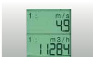
Visualizzazione di 2 parametri di misura
