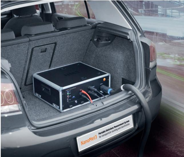
Einsatz des testo NanoMet3 bei einem RDE-Test (Test unter echten Fahrbedingungen).
