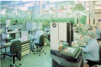
在无尘室和相邻房间之间保持规定的压力差，从而确保质量。
