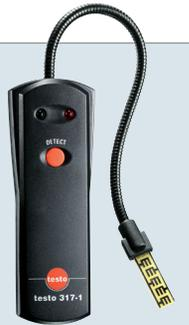
testo 317-1 rileva in modo affidabile eventuali reflussi dalle caldaie a camera aperta. La presenza di CO nell'aria ambiente viene subito segnalata dallo strumento, attraverso l'attivazione di un allarme ottico e acustico: l'ispezione visiva non è più necessaria. La sonda flessibile è ideale per raggiungere anche i punti di difficile accesso.
