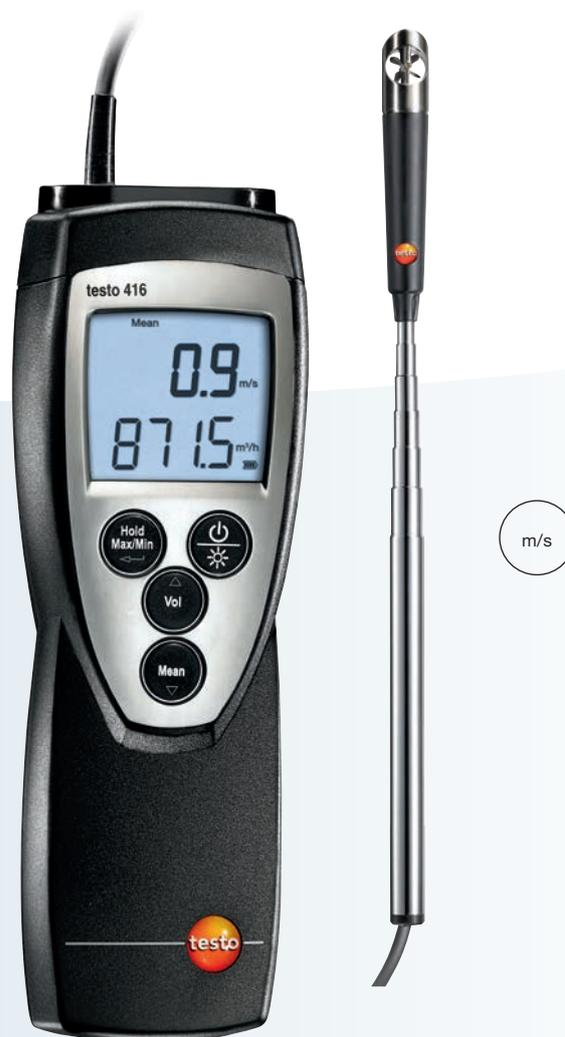
testo 416 ist ein kompaktes Anemometer mit fest angeschlossener Flügelradsonde. Mit dem ausziehbaren Teleskop (Länge max. 890 mm, Durchmesser 16 mm) eignet sich das Messgerät insbesondere zur Strömungsmessung im Kanal. Der Volumenstrom wird dabei direkt im Display angezeigt.
