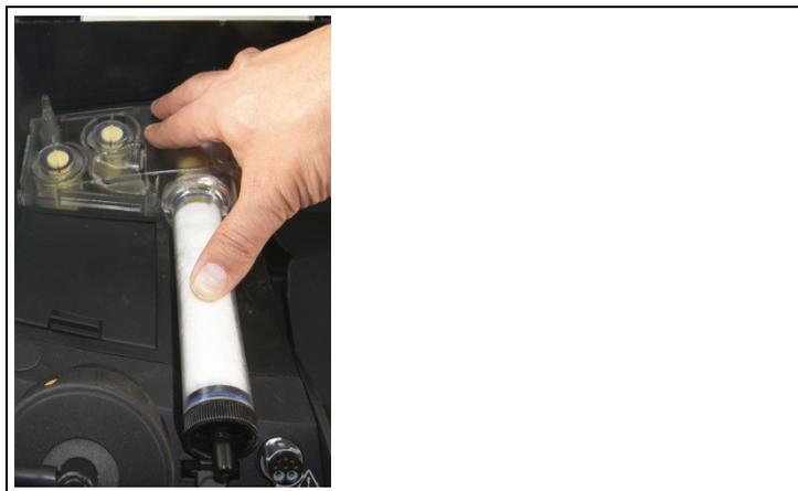
6. Mettre le réservoir de condensat en place dans le testo 380 et l'enclencher. Enficher le tuyau sur l'élément de raccord.
