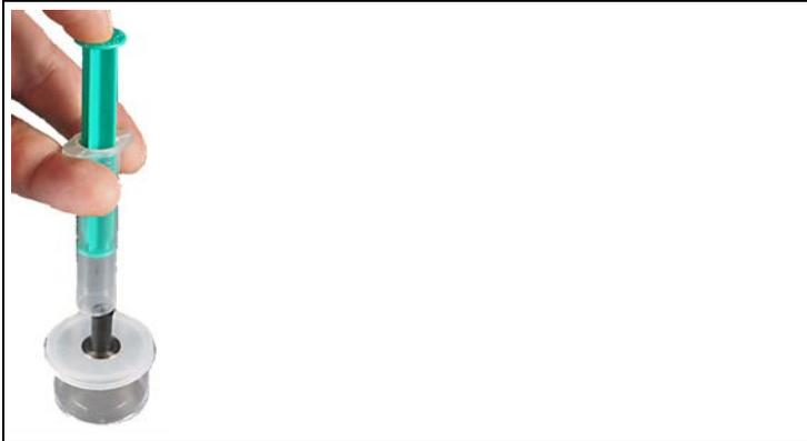
4. Placer la seringue et le tuyau sur la buse de manière à ce que l'eau ne s'échappe pas sur la garniture d'étanchéité.
