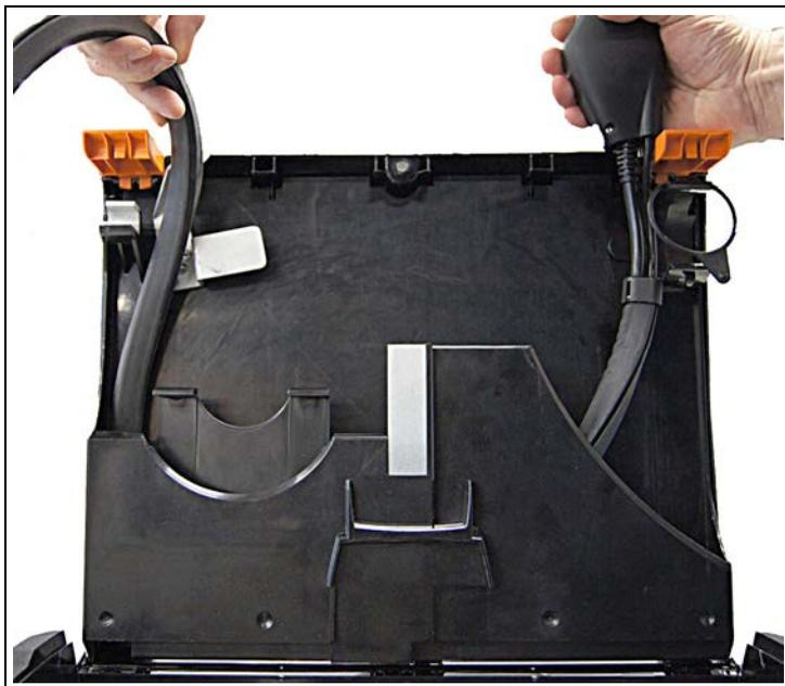
5. Placer le câble de la sonde dans le compartiment de rangement.
