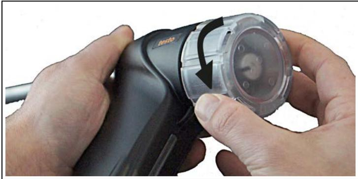
2. Ouvrir le capot du dilueur rotatif (tourner dans le sens contraire aux aiguilles d'une montre).
