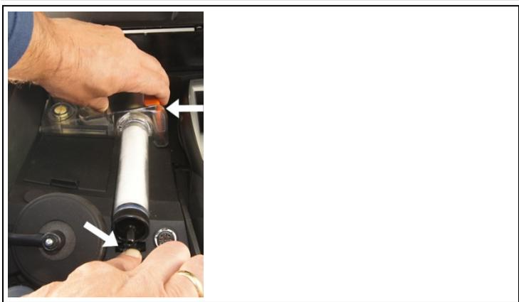
1. Retirer le tuyau de l'élément de raccordement du filtre en coton, détacher le filtre en coton au niveau du clip de maintien et déverrouiller le réservoir de condensat au niveau de la poignée orange.
