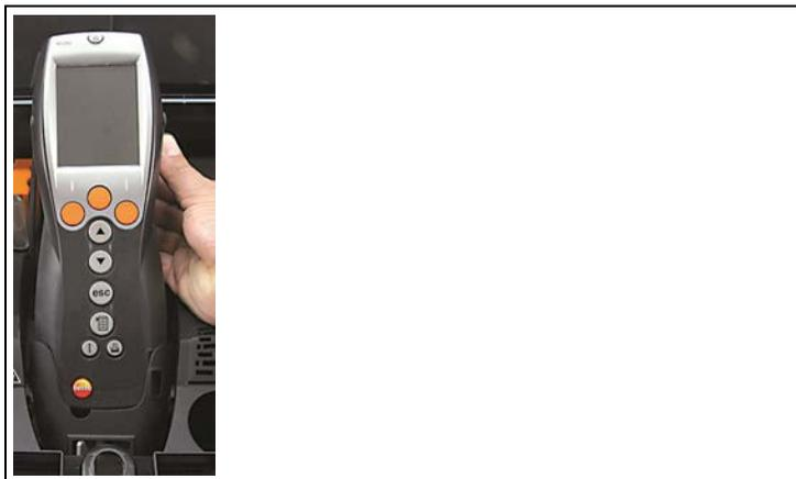
2. Relever la tablette pour le testo 330 et mettre l'appareil de mesure en place.
