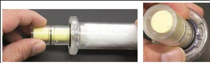
7. Fermer le boîtier du filtre primaire, le remettre en place sur le filtre en coton et appuyer. Tenir compte ici de la rainure dans le filtre primaire.
