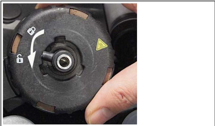
4. Faire tourner le capot de la sonde de poussières fines (dans le sens contraire aux aiguilles d'une montre) et le retirer.
