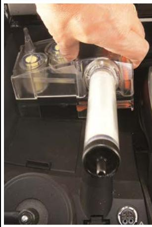
2. Retirer le réservoir de condensat à l'horizontale hors du testo 380.
