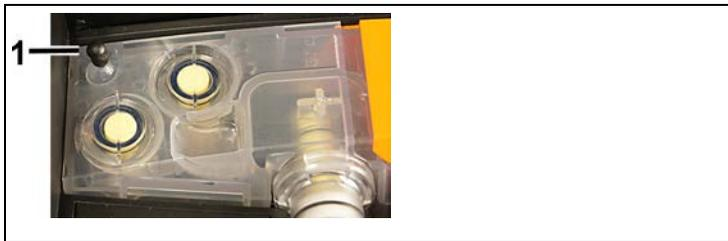
2. Enfoncer l'obturateur (1) sur l'entrée d'air frais du réservoir de condensat.
