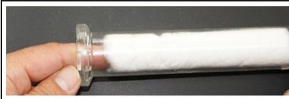
9. Remplir régulièrement la chambre du filtre avec 5 g d'ouate de coton neuve. Il n'est pas nécessaire de comprimer la ouate de coton.
