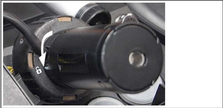
2. Déverrouiller le parcours de préchauffage (dans le sens contraire aux aiguilles d'une montre) et le retirer.
