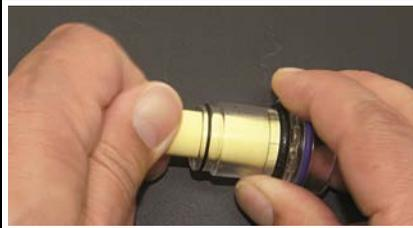
6. Retirer le filtre usagé et le remplacer par un neuf.
