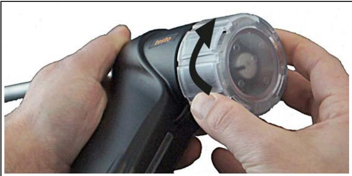
9. Fermer le capot du dilueur rotatif (tourner dans le sens des aiguilles d'une montre).
