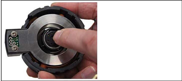
7. Tapoter légèrement avec l'index sur le module de la sonde.
