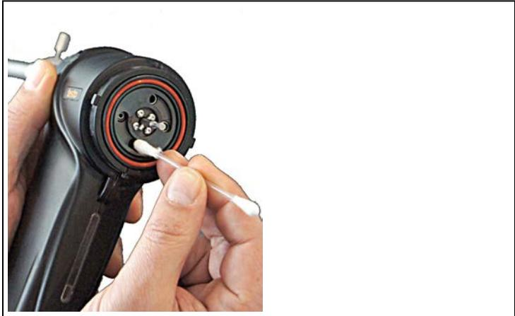
6. Nettoyer le disque du stator avec un coton-tige humide et sécher avec un coton-tige inutilisé.
