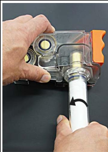
3. Faire tourner le filtre en coton (dans le sens contraire aux aiguilles d'une montre) et le retirer.
