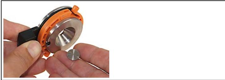
7. Retirer délicatement la buse du corps de la buse. Eviter au maximum de toucher la surface de la buse.
