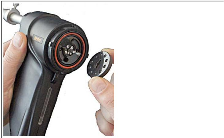
7. Mettre le disque de rotation en place (tenir compte de la goupille de blocage sur la sonde de poussières fines et de la courbure du disque de rotation).
