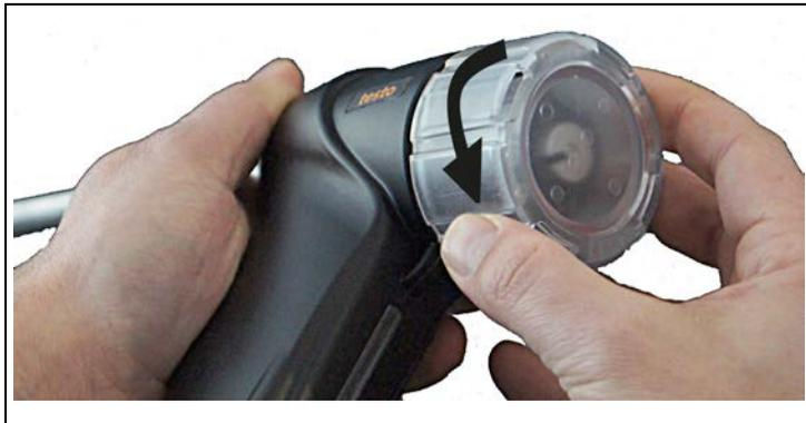
2. Ouvrir le capot du dilueur rotatif (tourner dans le sens contraire aux aiguilles d'une montre).
