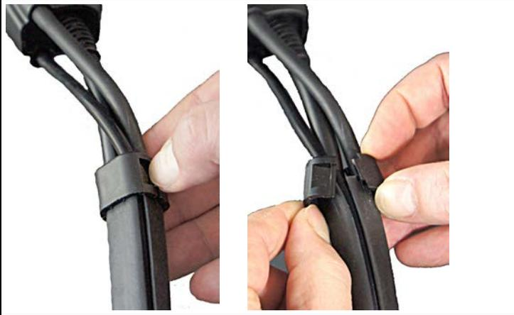
1. Ouvrir le clip de fixation et retirer le tuyau de la gaine de protection.
