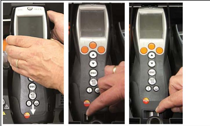
3. Mettre le testo 330 en place dans le support et le fixer avec le levier de blocage.
