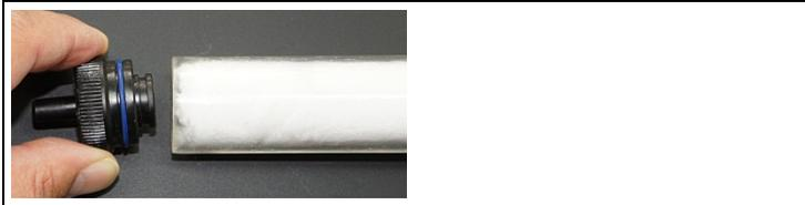
5. Retirer l'élément de raccordement de la chambre du filtre.
