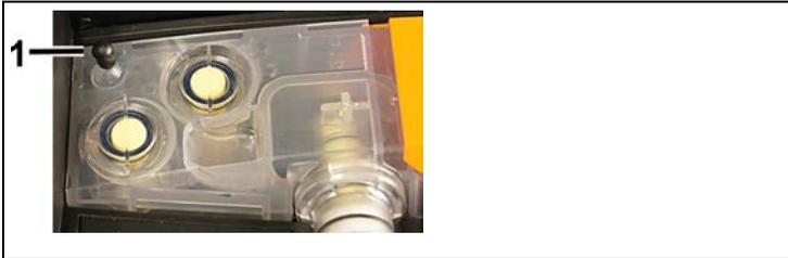
1. Enfoncer l'obturateur (1) sur l'entrée d'air frais du réservoir de condensat.
