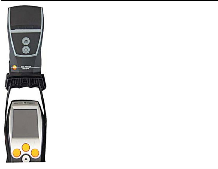
L'imprimante est fixée à la plaque magnétique (sur la partie supérieure du testo 330) pour le transfert des données entre le système de mesure et l'imprimante d protocoles IrDA.
