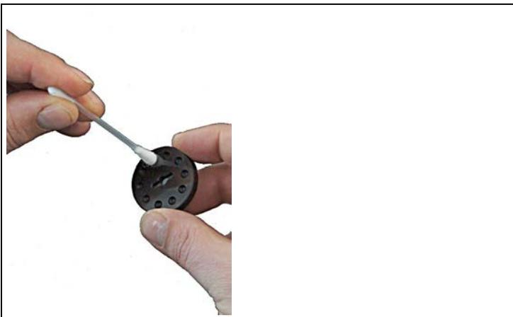
**i** Utiliser de l'eau distillée pour nettoyer les disques de rotation et du stator.
