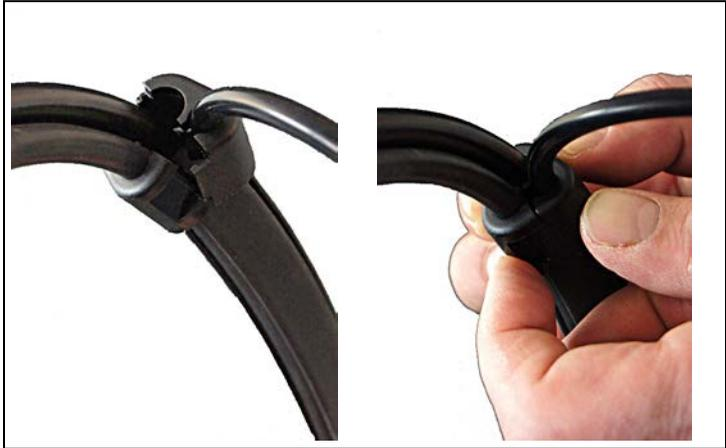
4. Insérer le tuyau de gaz brut et/ou de gaz de mesure dans une moitié du clip de fixation et resserrer les deux moitiés (clic audible).
