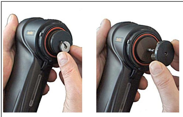
3. Abaisser l'élément de blocage et l'élément de serrage et retirer l'élément de blocage. Retirer ensuite l'élément de serrage sur l'arbre.
