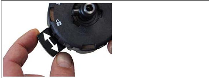
3. Déplacer le raccord enfichable à plusieurs reprises d'avant en arrière.
