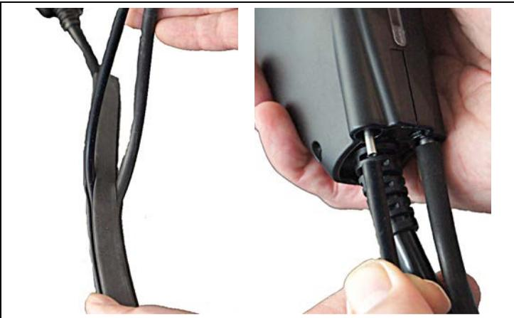
3. Mettre le nouveau tuyau de gaz brut et/ou de gaz de mesure en place. Lors de la mise en place, veiller à ce que le tuyau soit correctement placé dans la gaine de protection. Raccorder le
