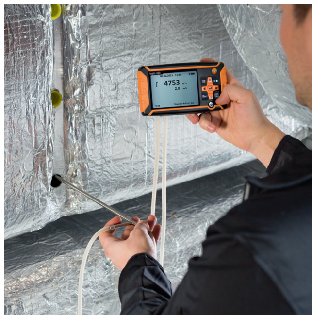
Instrument de detașabil permite măsurători cu tub Pitot în conducte (tub Pitot disponibil separat)
