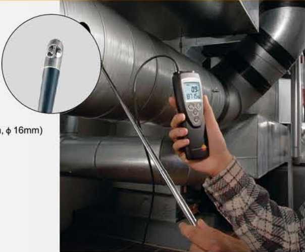
监测通风管道的风速
