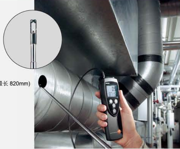
testo 425 监测通风管道的风速
