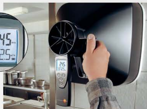
testo 417，检测墙面通风设备的排风量
