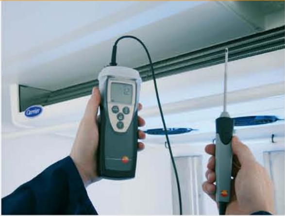
检测空调系统的温度
