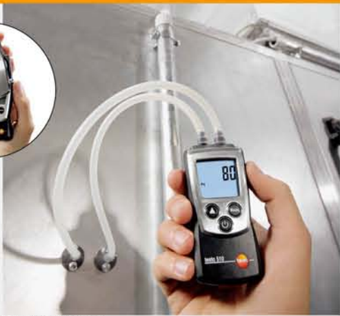
测量过滤器的差压
