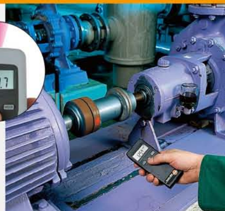
非接触测量转动部件的转速
