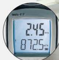
testo 417，检测墙面通风设备的排风量
