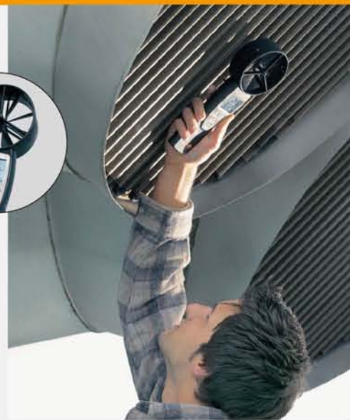
testo 417，检测通风口的空气流量
