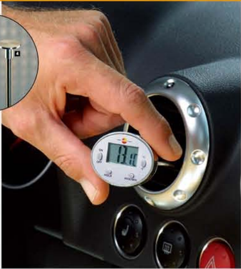
测量空调机组的温度
