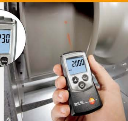
非接触测量机械的转速
